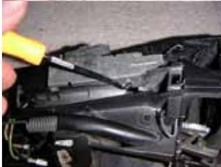
3)金属のカバーを外し通路を露出させます。
