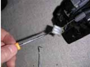
2)カブラー外しツールを使用して配線を抜き取ります。
