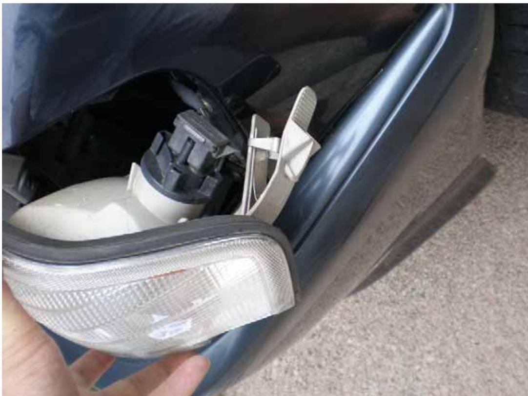
今度は、このウインカーをボディに押し込むことになるが、単に押しただけでははまらない。単に押しただけの状態の例。ヘッド・ライトとウインカーの間に隙間があることが目視できる。
