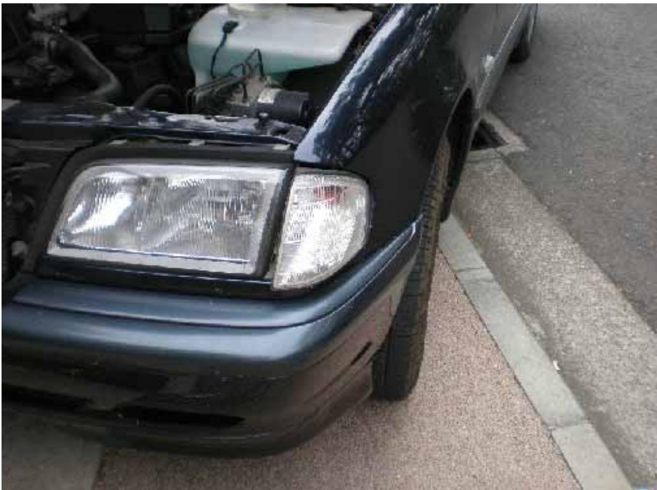
そこでウインカーと同じ目線で注意深く見てみるとウインカー側にオス、ヘッド・ライト側にメスの指し込み口が見える。ここにウインカーのオス状のフックを指し込み、カチンと音がするまで押し込む。カチンという音は、それほど大きな音ではない。
