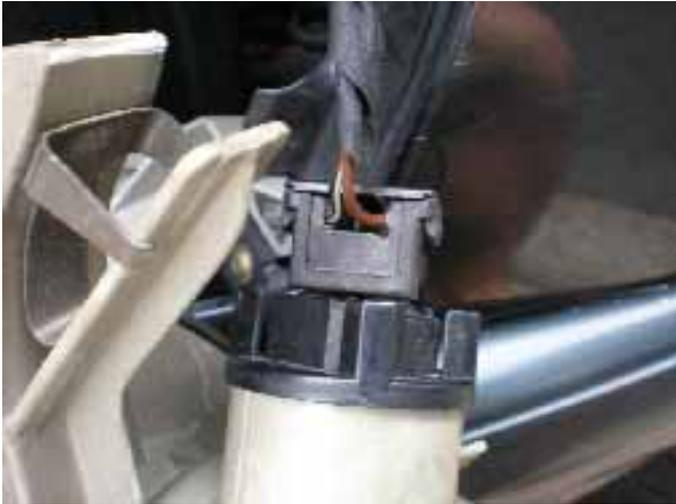
次に、ウインカーからケーブルを外す作業になる。単にソケットから引っ張れば外れるという構造になっていない。観察してみると蓋状のキャップがついている。このキャップの外し方は両サイドのツメを広げ気味にすると外れる。そして蓋を開けた後、ゆっくり引っ張るとケーブルとウインカーが離れる。
